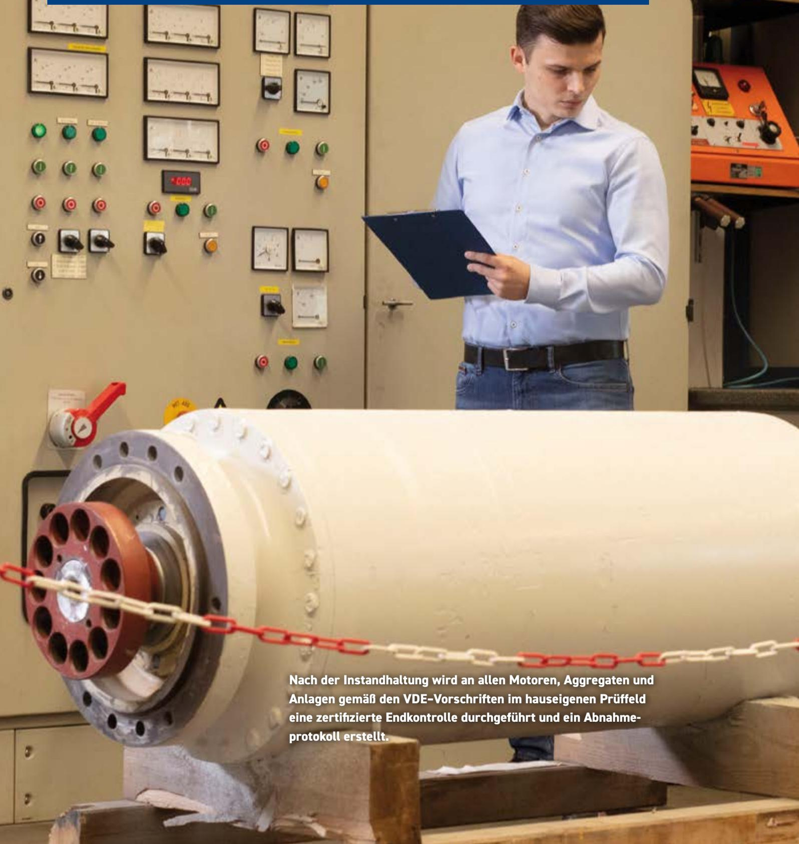
Nach der Instandhaltung wird an allen Motoren, Aggregaten und Anlagen gemäß den VDE-Vorschriften im hauseigenen Prüffeld eine zertifizierte Endkontrolle durchgeführt und ein Abnahmeprotokoll erstellt.
