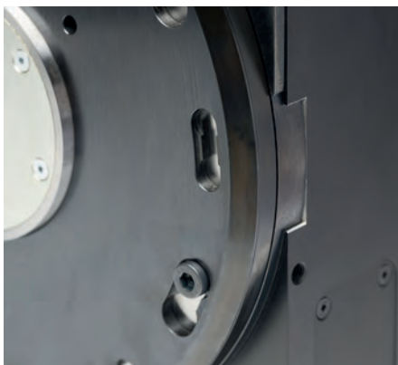
Die neu entwickelte Labyrinthdichtung.
