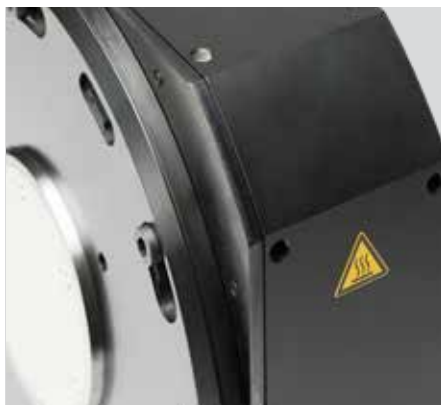
Solide Prallbleche schützen die Dichtung.
