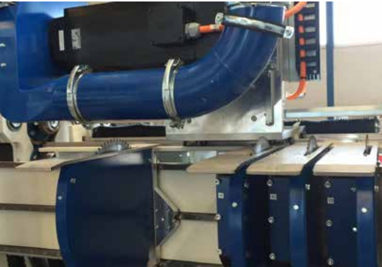
Die schmal bauenden Fischer Sägemotoren integrieren sich raumsparend in die Mehrblatt-Sägeanlage und überzeugen mit wirtschaftlichem sowie zuverlässigem Betrieb.
